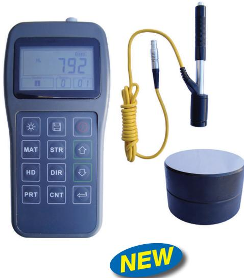
Durometro per metalli a rimbalzo per il controllo non distruttivo della durezza su svariati tipi di materiali e leghe. Consente: misurazioni in posizioni di difficile accesso o in spazi limitati test rapidi su pezzi di grandi dimensioni nonché su parti fisse di macchine; rilevamenti immediati in linea durante il ciclo di produzione o in accettazione/uscita merce
