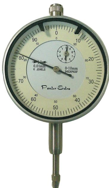
Movimento antiurto a frizione: il pignone centrale e la relativa ruota dentata sono indipendenti l'uno dall'altra. Il movimento tra i due ingranaggi avviene per trascinamento. Questo accorgimento, al momento dell'urto, consente alla ruota dentata di girare a corsa libera e pertanto evita che il colpo subito dall'asta scorrevole danneggi il complesso degli ingranaggi.
