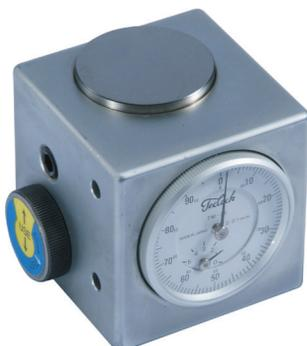
Strumento rapido e preciso per azzerare utensili su macchine tradizionali e CNC. Dopo aver posizionato l'azzeratore sul piano macchina è sufficiente avvicinarsi con l'utensile e premere sul piattello fino a che la lancetta del comparatore indicherà la quota di azzeramento (mm 50) precedentemente impostata. Base di appoggio magnetica (utilizzabile anche in orizzontale). Struttura rigida con piattello in acciaio temperato e rettificato. Pomolo laterale per l'azzeramento (Test) o l'utilizzo (Use)
