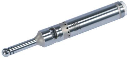
Particolarmente indicati per la ricerca di un punto zero di partenza per le lavorazioni su macchine utensili. Il display luminoso a 360° e il beep sonoro consentono la centratura o l'allineamento del pezzo da lavorare rispetto all'asse del mandrino portautensile e le misurazioni di altezze e profondità
