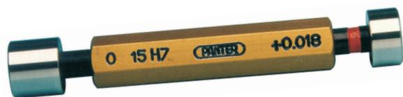
Parte calibrata in acciaio speciale legato, resistente all'usura, temperato a cuore, rinvenuto e stabilizzato. Superfinitura con lappatura finale. Impugnatura in duralluminio anodizzato con incisione della misura nominale e dei limiti di tolleranza. Normalmente disponibili dal  $\varnothing$  3 al  $\varnothing$  30 progr. 1 mm. A richiesta: esecuzione semplice (PASSA o NON PASSA) misure e/o tolleranze diverse.
