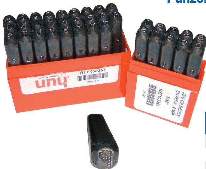
Adatti per marcature "a puntini" su acciai ad alta resistenza, acciai inox, leghe al Cr-Mo, lamiere ecc. Costruiti in acciaio trafilato, temperati progressivamente : da 60 HRc (carattere) a 35 HRc (testa duttile per assorbimento colpi)
